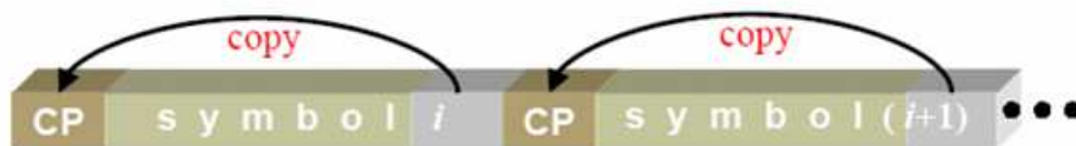
شکل ۲- افزودن باند محافظ به سیگنال OFDM
